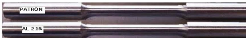
Figura 7: Probetas para el ensayo de resistencia a la Tracción
