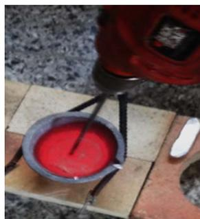
**Figura 6:** (a) Agitador en el baño fundido
